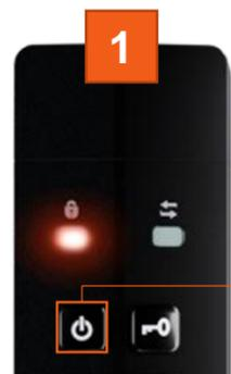
Нажмите кнопку питания, чтобы включить режим аккумулятора или подключите устройство к компьютеру
