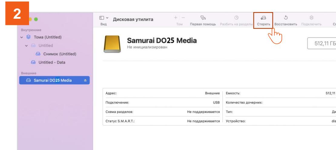
Затем переходим на диск и нажимаем «стереть»
