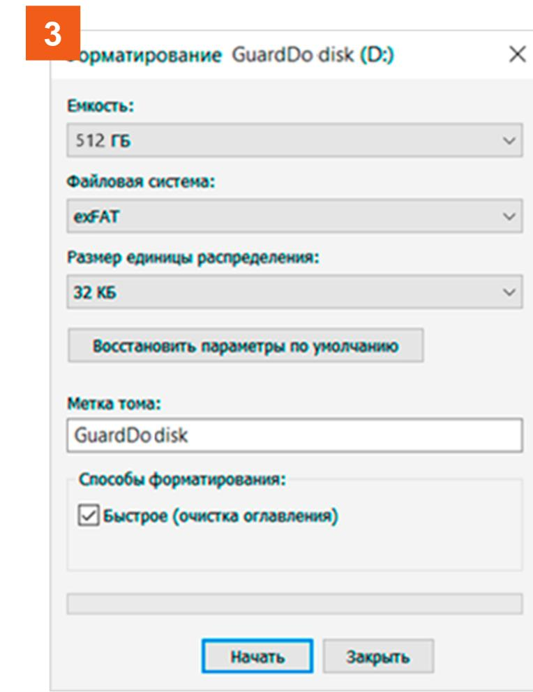
В разделе «файловая система» выбираем «ExFat» и нажимаем начать. Disk готова к работе
